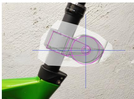
**Beschreibung:** Das Produkt des Fahrrad-Zugseilsystems ist in der Abbildung dargestellt. Angedacht ist eine Befestigung unterhalb des Sattels, um so beispielsweise eine Inliner fahrende Person ziehen zu können.
